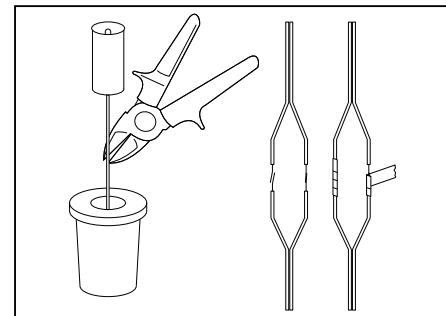
Bild 3, 4 & 5, Austausch des Dampfentwicklers
